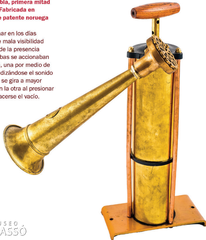
Sirena de niebla, primera mitad del siglo XX. Fabricado por Kockums Verkstad, Malmo (Suecia). Patente registrada en 1910
