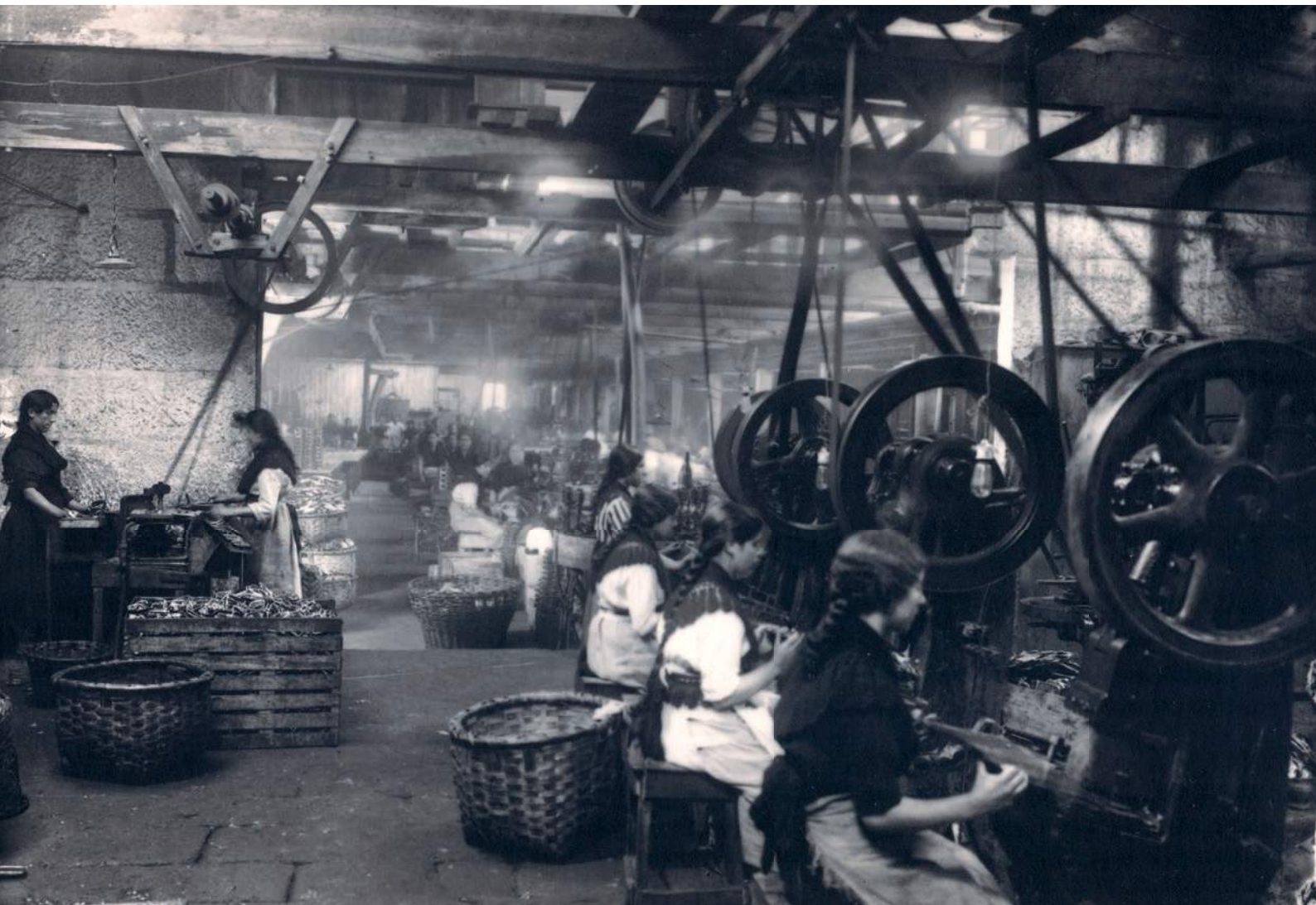
Sección de marcaje de la hoja de lata en la conservera Massó Hermanos S.A. de Bueu, del estudio fotográfico Pacheco de Vigo, 1924
